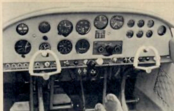
VÖLLIG NEU und ausgezeichnet gelungen ist die Anlage der Doppelsteuer. Der Bogen im Knüppelrohr bedeutet sehr viel Bequemlichkeit für den Flugzeugführer. Sehr angenehm ist auch die vernünftige Anordnung der Handräder für die Landeklappen und für die Trimmung.
