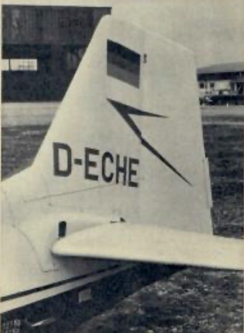
GROSSZÜGIGE VERGLASUNG und ein bequemer Einstieg tragen zur hervorragenden Sicht und zur gelungenen Gesamtausstattung der vierseitigen Kabine bei (oben). — Die Ästhetiker bei Bölkow finden gewiß für die erste Serie der 207 eine aerodynamisch noch günstigere und gefälligere Form der Verkleidung über der Höhenflossenverstellung (unten).
